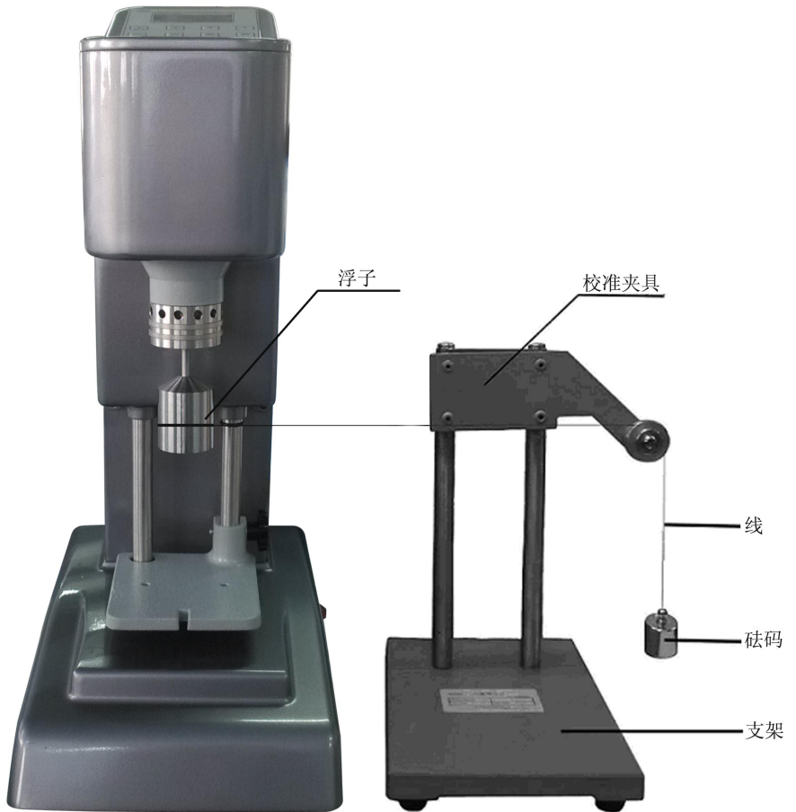
图（五）静负载校准装置
